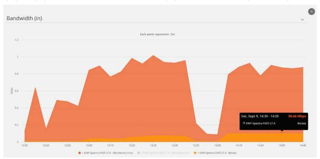
FAST UDP multicast трафик в тесте достигал в каждой копии A и B 100 Mbps с пиками до 1 Gbps.
