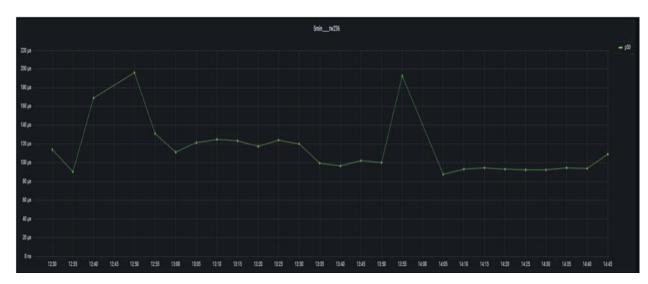
В диапазоне частот транзакций от 5 000 до 20 000 в секунду медианные величины времен RTT транзакций участников для TWIME шлюза изменяются от 90 мкс до 120 мкс. Пик на графике в период с 12:30 до 13:00 обусловлен проведением аукциона открытия на срочном рынке. Пик на графике с 13:50 до 14:05 обусловлен проведением промклиринга на срочном рынке.
