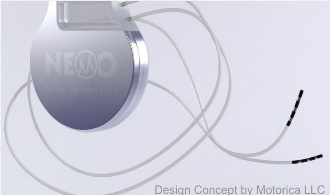
**По итогу второго этапа исследований команда разработала прототип нейромодуляционной платформы, электростимуляторы и электроды.**
