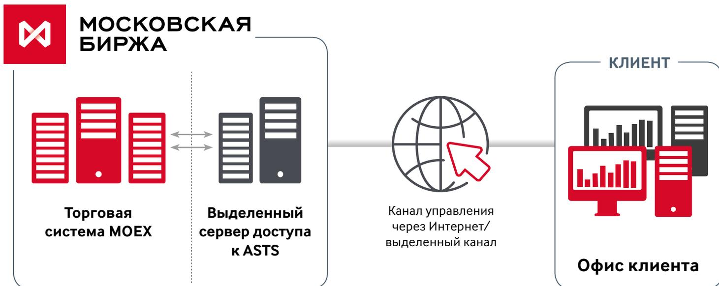
**СЕРВЕР ДОСТУПА (GATEWAY)** — программно-аппаратный комплекс, предназначенный для обеспечения доступа Участников торгов к центральному звену Торгово-клиринговой системы ASTS валютного, фондового и денежного рынков.
