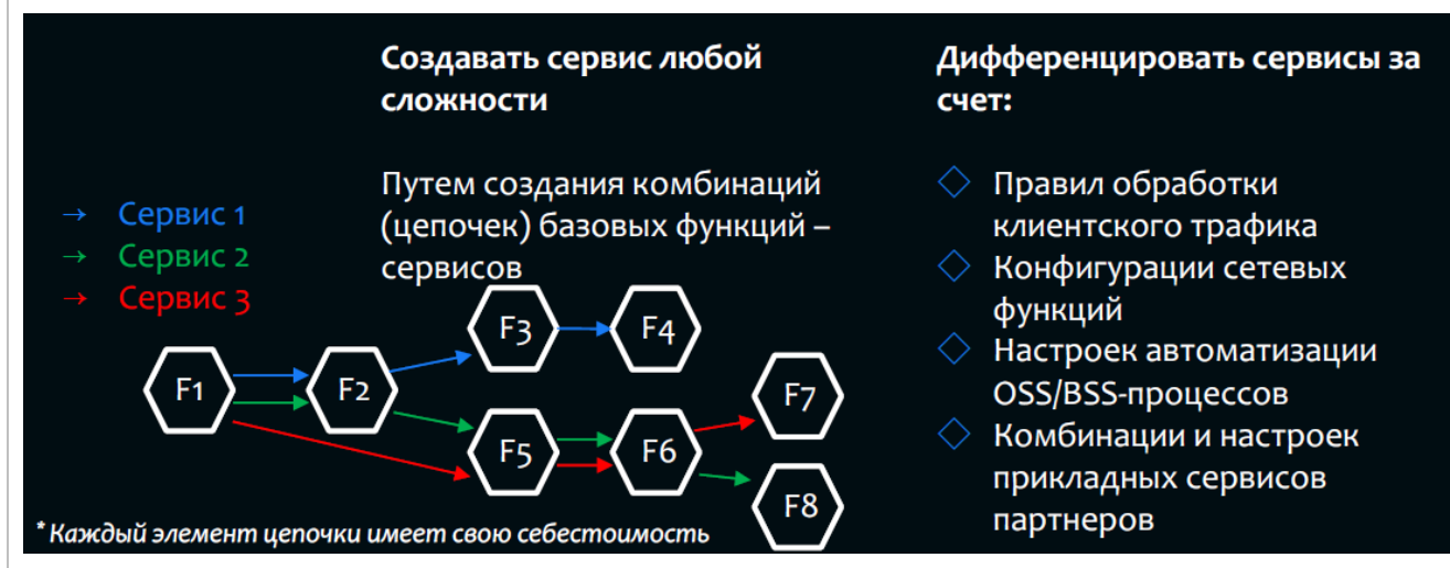
Рис. 23. Описание принципа программного создания сервиса V2B2X путем формирования сервисных цепочек виртуальных (программных) функций с использованием платформы оркестрации виртуальных функций
