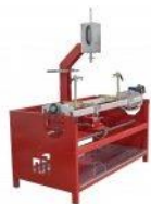
Пневматические рассухариватели для удобства сборки/разборки клапанной группы
