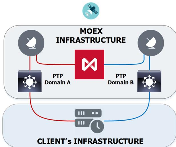
Оборудование Биржи получает сигналы точного времени GPS в физически зарезервированных точках: двое Grandmaster-часов, каждые из которых с собственной GPS-антенной.
